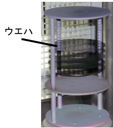
ボートがチャンバー内にセットされている状態
