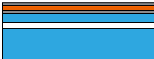
図 1.2 下部電極、PZT、上部電極をスパッタ成膜
