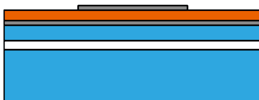
図 1.3 上部電極をドライエッチング
