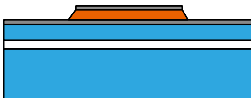
図 1.4 PZT薄膜をドライエッチング
