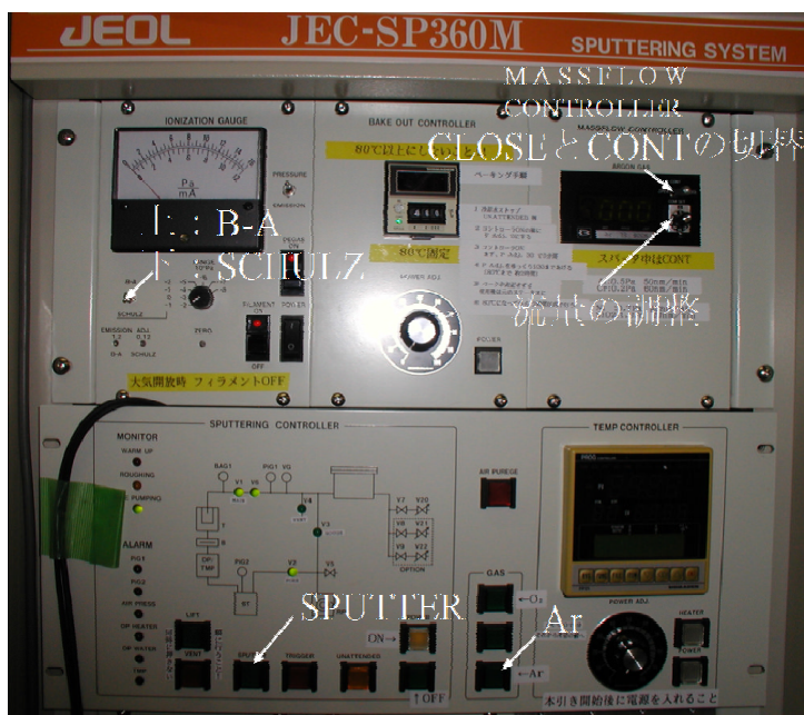
図4 Arガス投入
