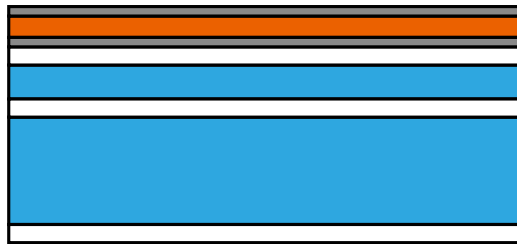
図 1.2 下部電極、PZT、上部電極をスパッタ成膜
