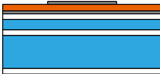
図 1.3 上部電極をドライエッチング
