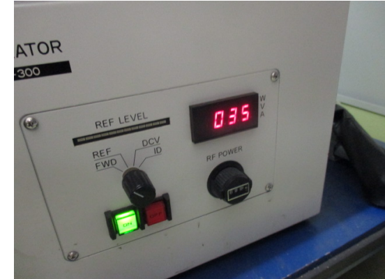
内部RF電源部出力表示
